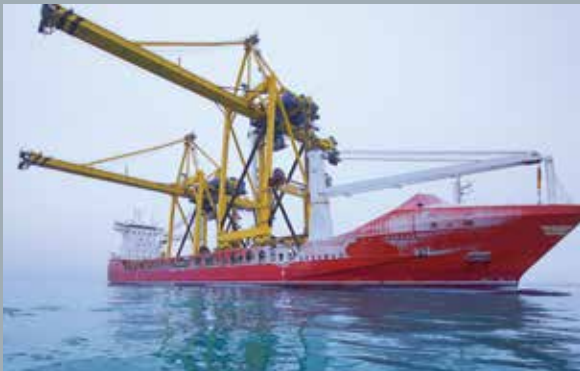
Транспортировка 2-х контейнерных перегружателей типа STS в собранном виде из порта Санкт-Петербург в порт Восточный по Северному морскому пути
