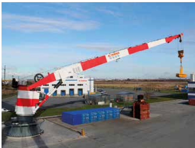
Судовой кран «С 1700» на испытательном стенде №1
